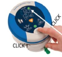
Schieben Sie das PAD-PAK™ in die Öffnung hinein, bis ein Klicken ertönt. Dieses Klicken weist darauf hin, dass das Pak korrekt eingesetzt wurde.
