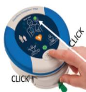
Insérez le PAD-PAK™ dans l'ouverture jusqu'à entendre le « clic » pour être sûr(e) qu'il soit correctement inséré
