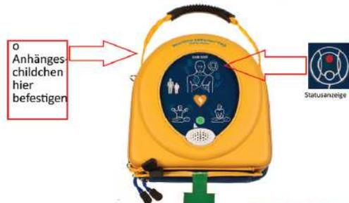
FALLS DIE LED-ANZEIGE IHRES GERÄTS **ROT ODER GAR NICHT LEUCHTET** UND SIE ES BEI EINEM PLÖTZLICHEN HERZSTILLSTAND BENÖTIGEN, ERSETZEN SIE DAS INSTALLIERTE PAD-PAK DURCH EIN RESERVE-PAD-PAK UND BEACHTEN SIE DABEI DIE ANLEITUNG AUF DER RÜCKSEITE.
