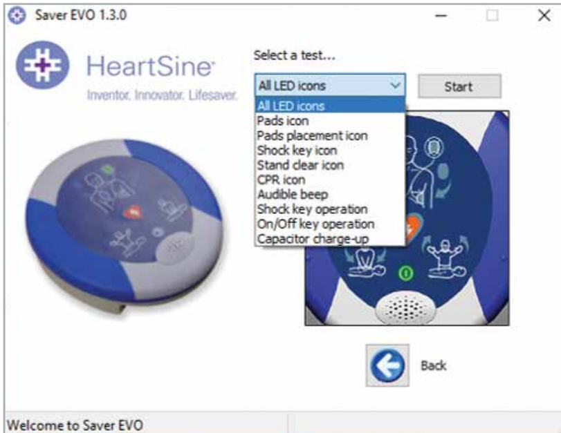
Παράθυρο διαγνωστικών ελέγχων Saver EVO PAD
