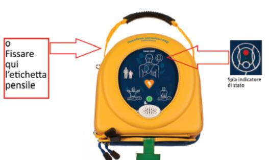
SE IL LED DEL DISPOSITIVO È **ROSSO O SPENTO** E SE NE HA BISOGNO IN UN EVENTO DI ARRESTO CARDIACO IMPROVISO, SOSTITUIRE IL PAD-PAK INSTALLATO CON QUELLO DI RISERVA SECONDO LE ISTRUZIONI RIPORTATE SUL RETRO.
