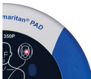
Figure 10. Voyant rouge clignotant ou signal sonore ; voir Dépannage en Annexe B.
