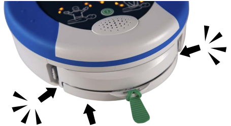
Mynd 4. Nýrri Pad-Pak einingu komið fyrir
