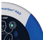
Figura 11. LED verde intermitent; nu este necesară nicio acțiune.
