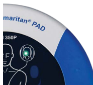
Slika 11 Utripanje zelene lučke LED, ni potreben ukrep.
