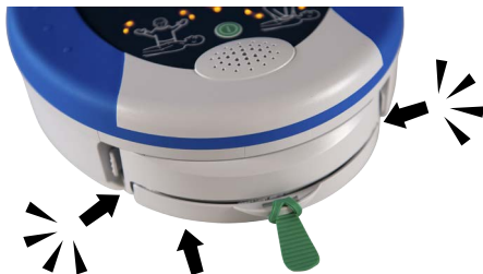
Slika 4 Vstavljanje paketa Pad-Pak
