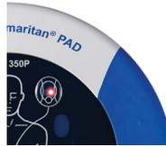
**Figura 10.** Luz vermelha intermitente e/ou sinal sonoro; Ver Resolução de problemas no Anexo B.
