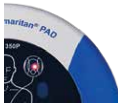
Kuva 9. Vilkkuva punainen valo ja/tai äänimerkki; katso Vianmääritys liitteessä B.
