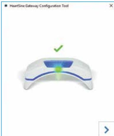
12. Il modulo HeartSine Gateway tenta di connettersi alla rete Wi-Fi. Se la connessione riesce, l'indicatore di stato del modulo HeartSine Gateway sarà verde fisso prima di spegnersi. Se la connessione non riesce, l'indicatore diventa blu lampeggiante. In questo caso è probabile che le informazioni immesse per la rete non siano corrette e debbano essere reimmesse. Verificare che i dati in possesso siano corretti e ripetere tutta la procedura.
