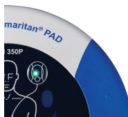
Figur 11. Blinkende grønn LED, ingen handling nødvendig.
