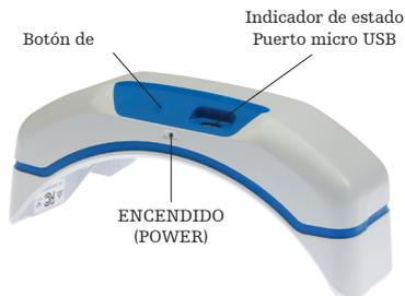
**Botón de ENCENDIDO (POWER):** Presione este botón para encender el HeartSine Gateway o presione y mantenga presionado el botón durante seis segundos para poner el HeartSine Gateway en modo configuración.
