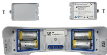
3. Instale las cuatro pilas CR123A suministradas. Asegúrese de colocar las pilas tal como se indica en el compartimiento correspondiente del HeartSine Gateway.
