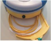
트레이너 패드 - 팩이 완전히 충전되었는지 확인하십시오 (본 매뉴얼의 충전하기 편을 참고). 하트싸인 사마리안® PAD 트레이너와 트레이너 패드 - 팩을 평평한 표면 위에 놓으십시오. 트레이너 패드 - 팩이 잘 삽입되었는지 딸깍 소리가 날 때까지 트레이너 패드 - 팩을 하트싸인 사마리안® PAD 트레이너의 입구에 밀어 넣으십시오.
