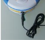
그림과 같이 트레이너 패드 - 팩에 있는 소켓에 충전기 어댑터를 삽입하십시오. 어댑터가 완전히 삽입되었는 지를 확인하십시오.
